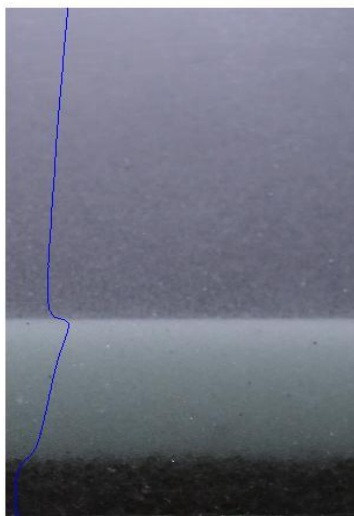
Figura 2.- Algoritmo usado para la detección de los diferentes estratos, en base al promedio de la intensidad de luz (línea azul).
