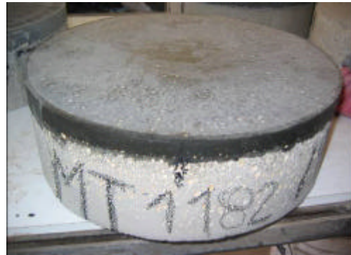
Figura 8 b: Probeta de hormigón revestida con Master Top 1182C. ADA = 0 mm
