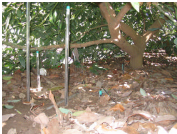
Foto 1. Tasas de cerámica a profundidades de 30, 60, 90 y 120 cm. Instaladas sobre los camellones de paltos.
