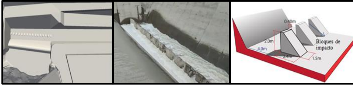
Figura N° 2: Bloques de impacto para disminuir la agitación turbulenta del canal colector.
