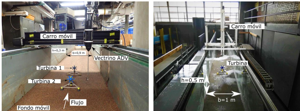
Figura 1: Canales utilizados para las mediciones experimentales. En ambas imágenes se puede apreciar el carro móvil utilizado para las mediciones con los distintos instrumentos y la configuración analizada.
