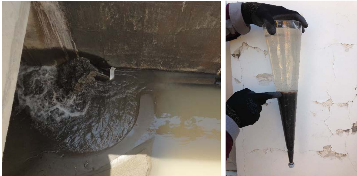
Figura 9. Punto de salida y muestra de concentración con el cono Imhof
