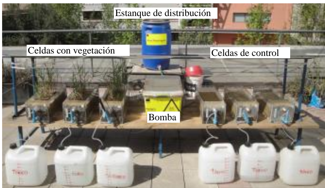
Figura 1. Instalación experimental. A la izquierda se encuentran las tres celdas con vegetación, al medio la bomba peristáltica y el estanque de distribución con el agua sintética, y en la derecha se encuentran las tres celdas de control.
