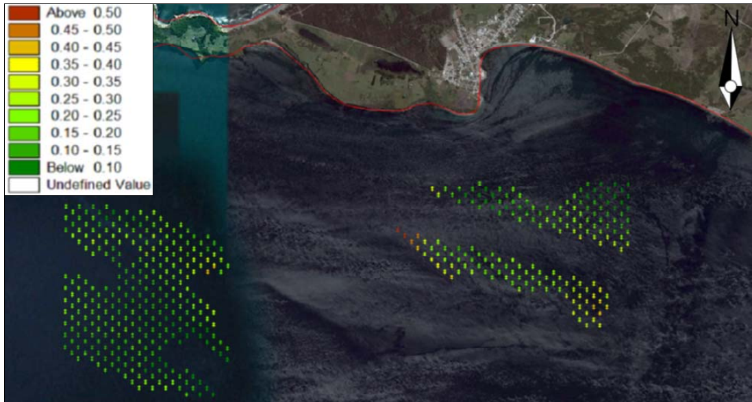
Figura 10: Factores de planta por cada Seagen en escenario bondadoso. Fuente: Elaboración Propia.
