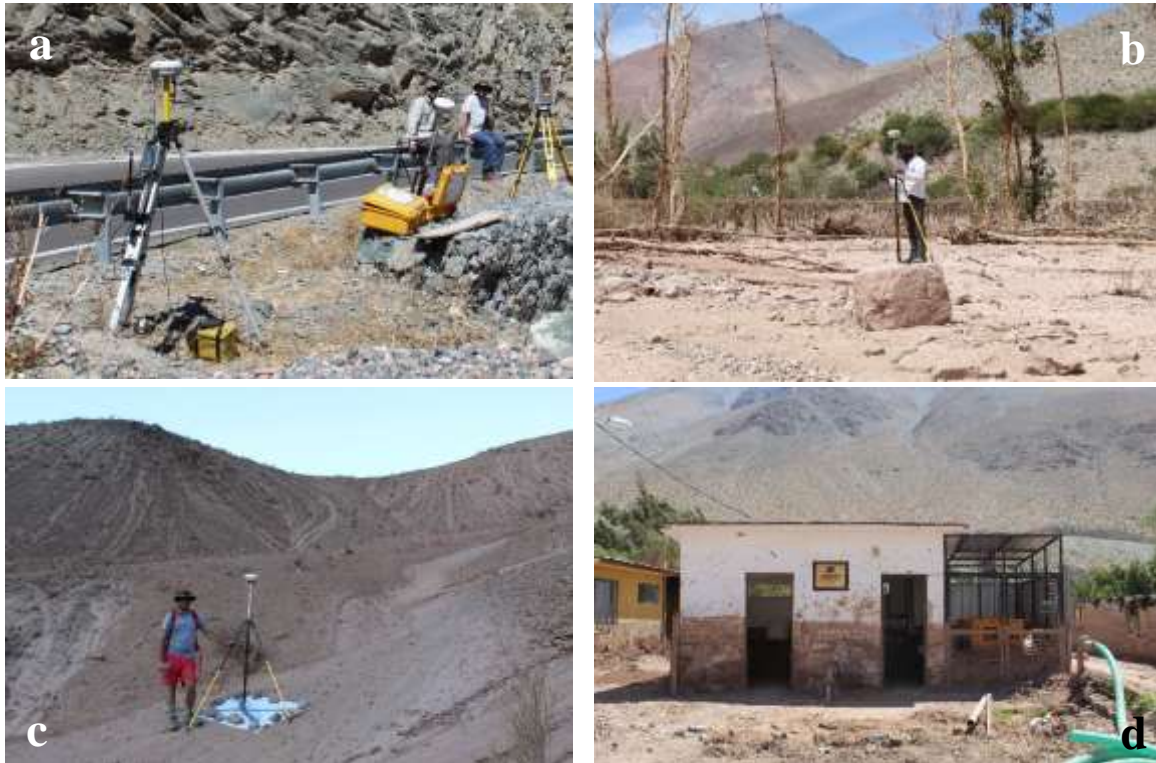
Figura 2. Trabajo de terreno. La georreferenciación de puntos de control se lleva a cabo con un GPS diferencial que consta de 2 antenas: (a) estación base y (b) estación móvil. (c) banderas que se identifican en las imágenes adquiridas por el vuelo dron. Estas banderas facilitan la georreferenciación del modelo de elevación digital. (d) medición de la altura de escurrimiento y depósito basado en marcas en paredes.
