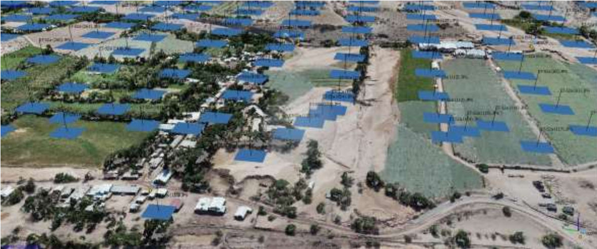
Figura 3. Nube de puntos densa generada por Agisoft PhotoScan. Los rectángulos azules corresponden a la ubicación del dron al momento de adquirir cada imagen.
