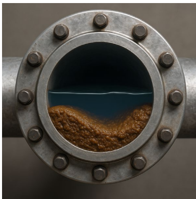
Figura 5: Tubería con presencia de biopelículas
