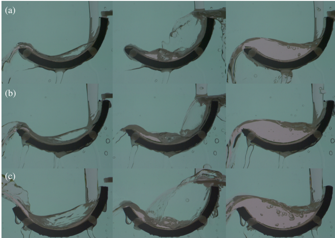
Figura 2. Imágenes experimentales de la transición desde una condición estable supercrítica a una condición subcrítica mediante una perturbación externa, para tres curvas y caudales distintos: a) \theta_c \approx 132,83^\circ y Q \approx 0,041 l/s, b) \theta_c \approx 135,57^\circ y Q \approx 0,051 l/s, c) \theta_c \approx 150,00^\circ y Q \approx 0,083 l/s.
