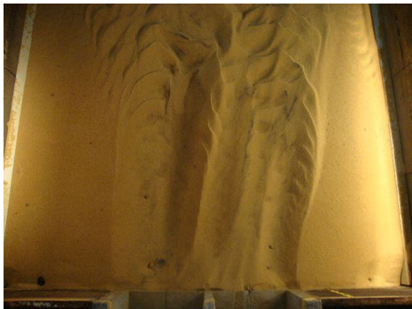
Figura 6. Desarrollo en el tiempo de la fosa de socavación.
