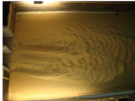
Figura 6. Desarrollo en el tiempo de la fosa de socavación.
