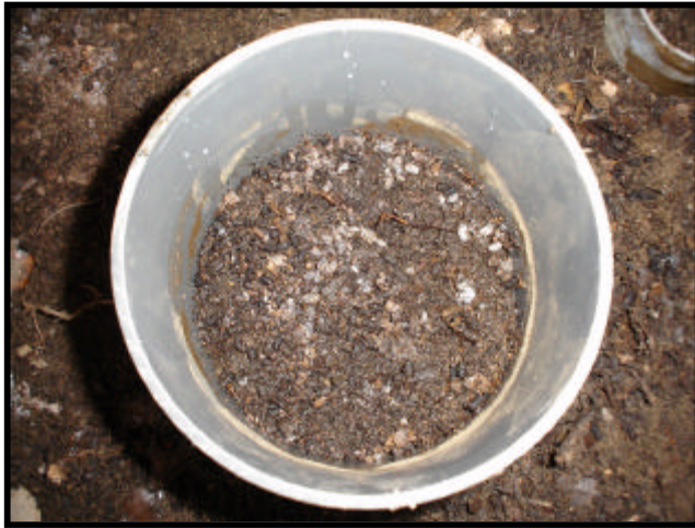
Tubo de PVC utilizado en la experiencia. Diámetro: 10 cm.
