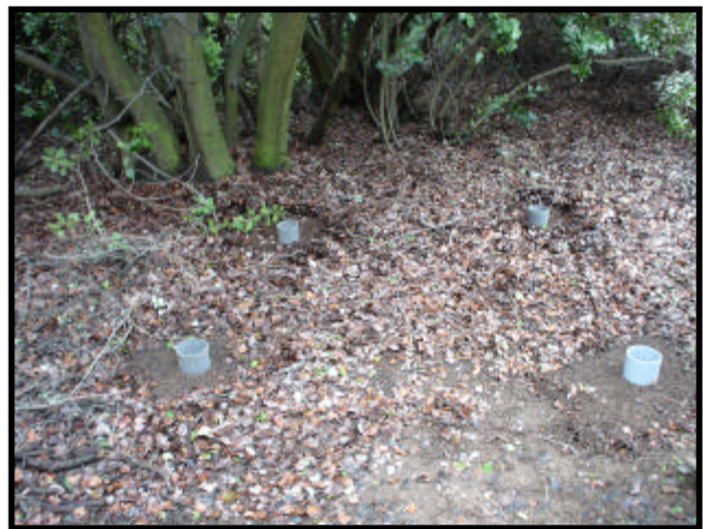
Tensioinfiltrómetro usado para comparar los resultados obtenidos con el método de Beerkan.
