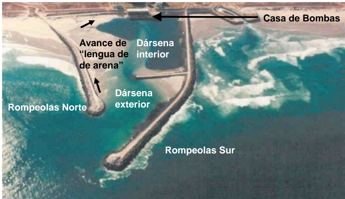
Figura 1: Vista aérea de dársena, con lengua de arena avanzando paralelamente al rompeolas Norte, 5 Abril 2000.
