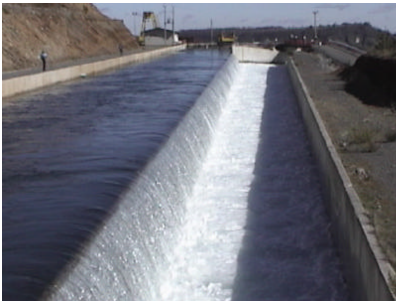
Foto 2 Régimen permanente final (la marca de agua en la pared izquierda indica el tránsito del frente de onda)
