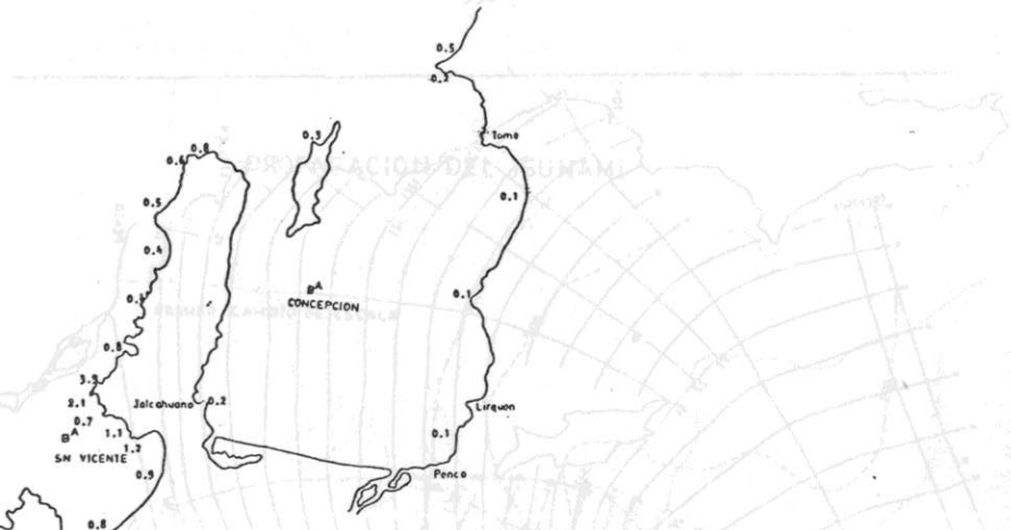
Fig. 9 Altura de Ola Esperada para un Tsunami Cercano, Generado por un Terremoto de Magnitud M_s = 7.5 (en metros)
