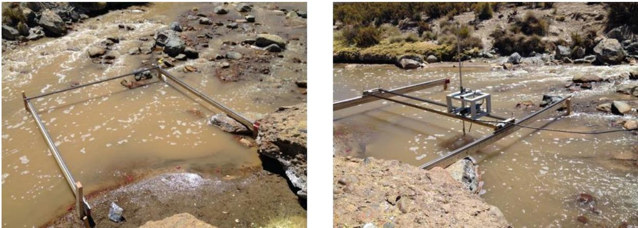
**Figura 2.** Montaje de la configuración de terreno para las mediciones con ADV.
