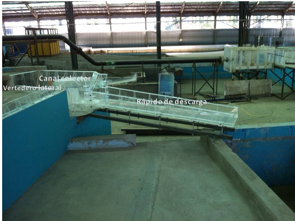
Figura 2: Disposición general del modelo físico en el laboratorio del INH.
