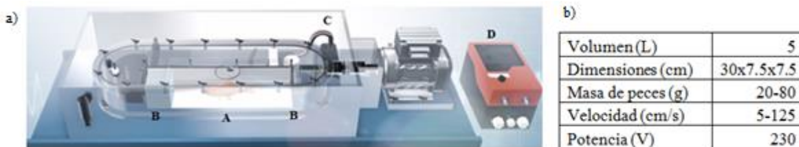
Figura 2. Túnel de natación. a) Vista general indicando sus componentes principales; b) Especificaciones técnicas de Loligo System, modelo SW10050.
