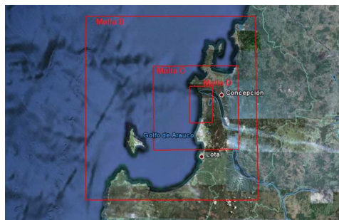
Figura 5. Representación espacial de las mallas B de 27", C de 9" y D de 3" que se utilizaron de las modelaciones numéricas.
