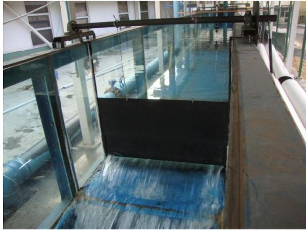
Figura 3. Compuerta deslizante en operación
