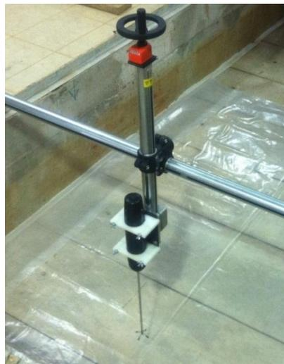
Figura 2. ADV y estructura
