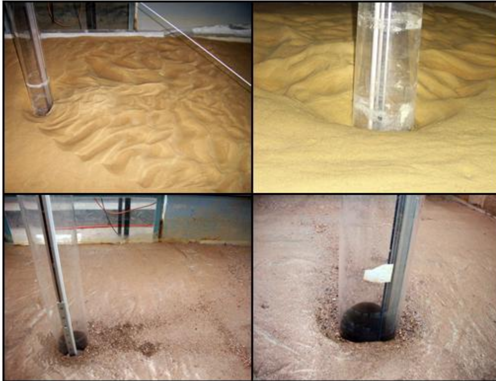
Figura 4 Superior: socavación en arena después de 30 horas. Inferior: socavación en sedimento del estero Chaimávida, después de 60 horas
