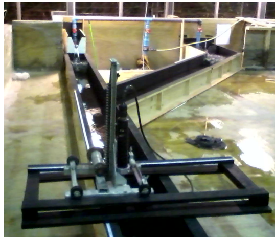
Figura 4: Confluencia experimental en el laboratorio mirado desde aguas abajo hacia aguas arriba. El número de Froude, el ángulo, y la razón de cantidad de movimiento son iguales a la confluencia entre los ríos Azufre y Caracarani.
