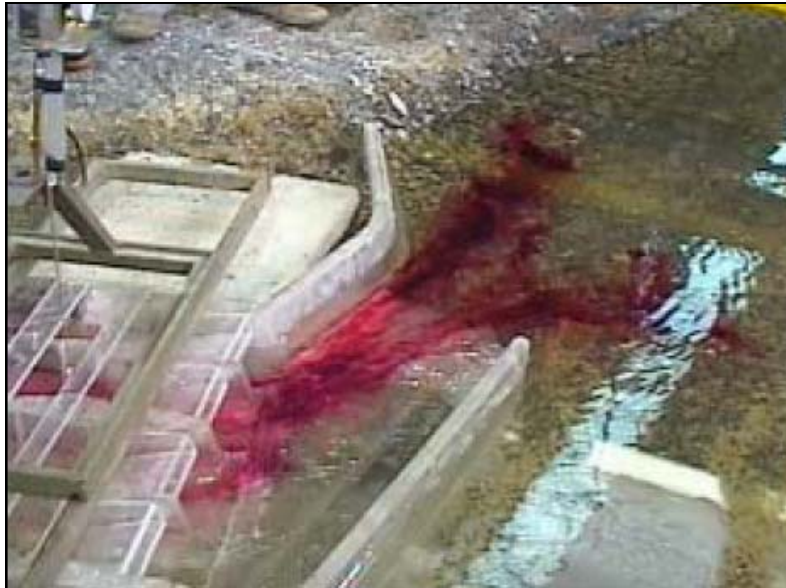
FIGURA 7: DISTRIBUCIÓN LINEAS DE FLUJO EN LA TOMA
