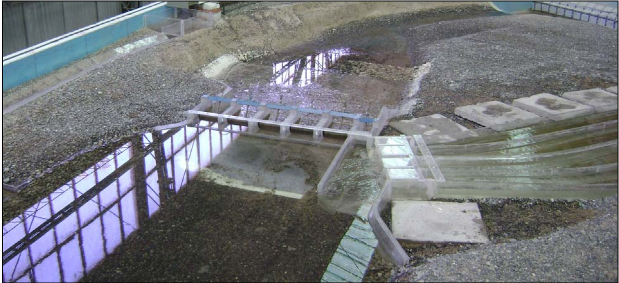
FIGURA 5: MODELO FÍSICO BOCATOMA CHACAYES
