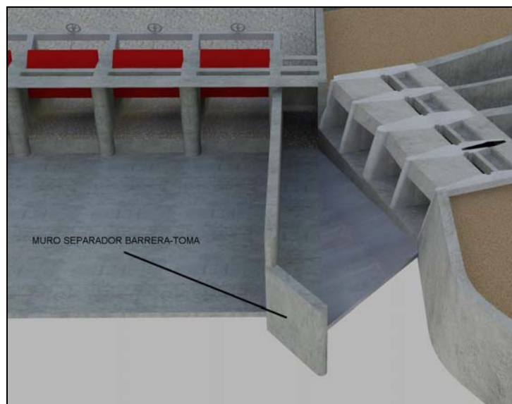
FIGURA 6: DISPOSICIÓN MURO SEPARADOR
