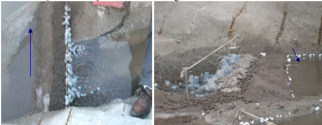
Figura 10: Vistas superior y lateral de la preataguía en su situación final. Q = 800 \text{ m}^3/\text{s} y material de relleno grueso N° 2. Modelo Pascua.
