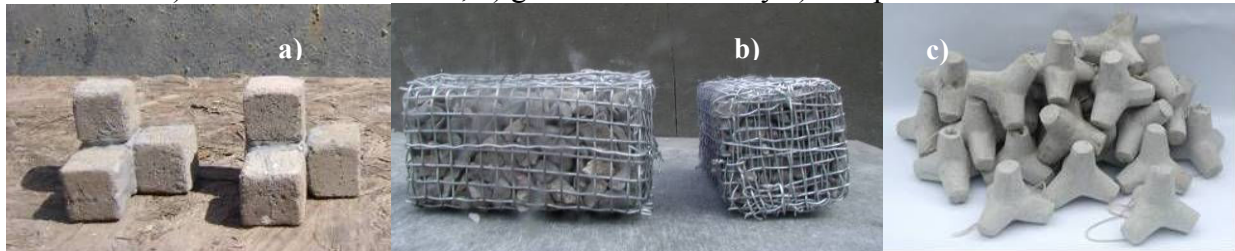
Figura 6: Elementos prefabricados considerados en el cierre del río. Modelo Baker.
