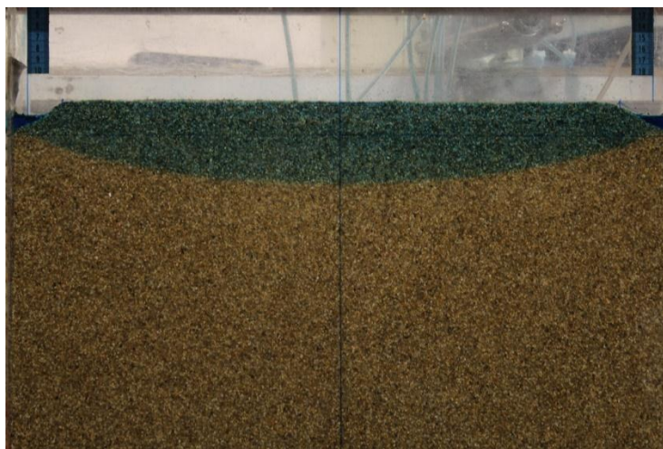
Figura 1: Forma de la interfaz de densidad en régimen permanente para la experiencia 3. La interfaz corresponde a la frontera entre las zonas con distinto color.
