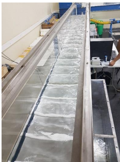
Figura 2. Vista superior del canal hidráulico ubicado en el LEIC. En la figura se pueden observar los obstáculos uniformemente distribuidos, como también el equipo computacional de registro a un costado del canal.
