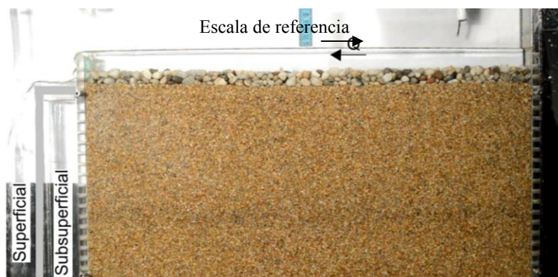
Figura 1. Montaje experimental y configuración del lecho utilizado para la medición de percolaciones en el subsuelo hasta 0.48 m, flujo subsuperficial y flujo superficial.
