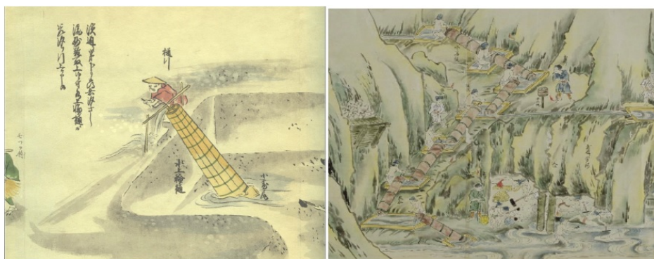
Figura 7.- Dibujos obtenidos de Rollos de Minería de Oro en la Isla Sado en Japón Izquierda: Tornillo de Arquímedes único (Winkelmann, 1964) Derecha: Tornillo de Arquímedes séptuple (National Archives of Japan Digital Archive)
