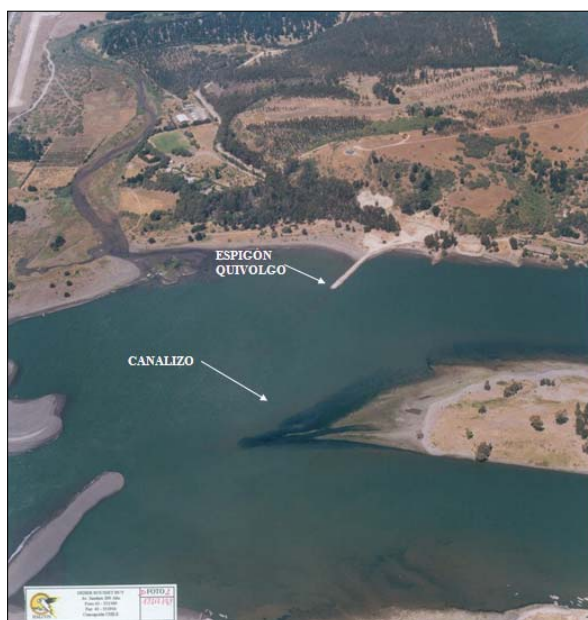
Figura 13.- Vista aérea del canalizo formado por el espigón Quivolgo y la punta de aguas abajo de la isla Orrego (DOP, diciembre de 1998).
