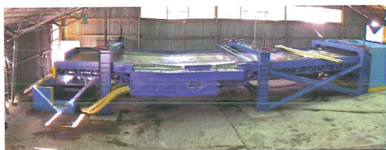
Figura 1.- Vista General del Banco de Pruebas de Sumideros de Aguas Lluvias del INH.
