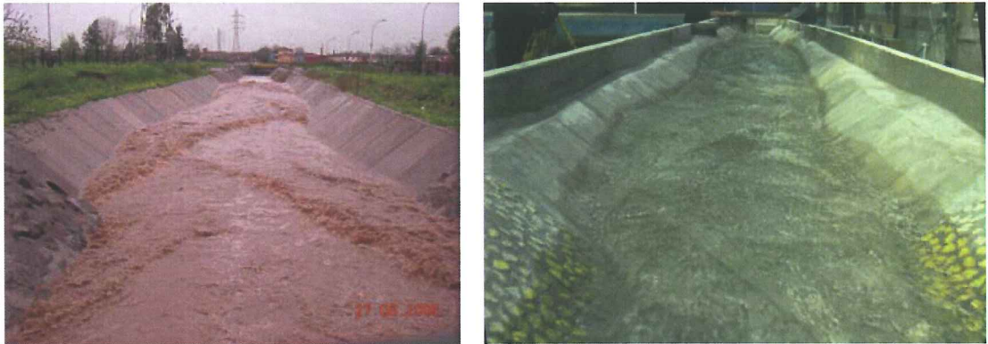
Figura 3. Comparación Naturaleza (izq) y Modelo Físico Reducido (der)
