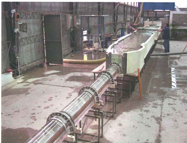
Modelo Hidráulico en escala reducida.
